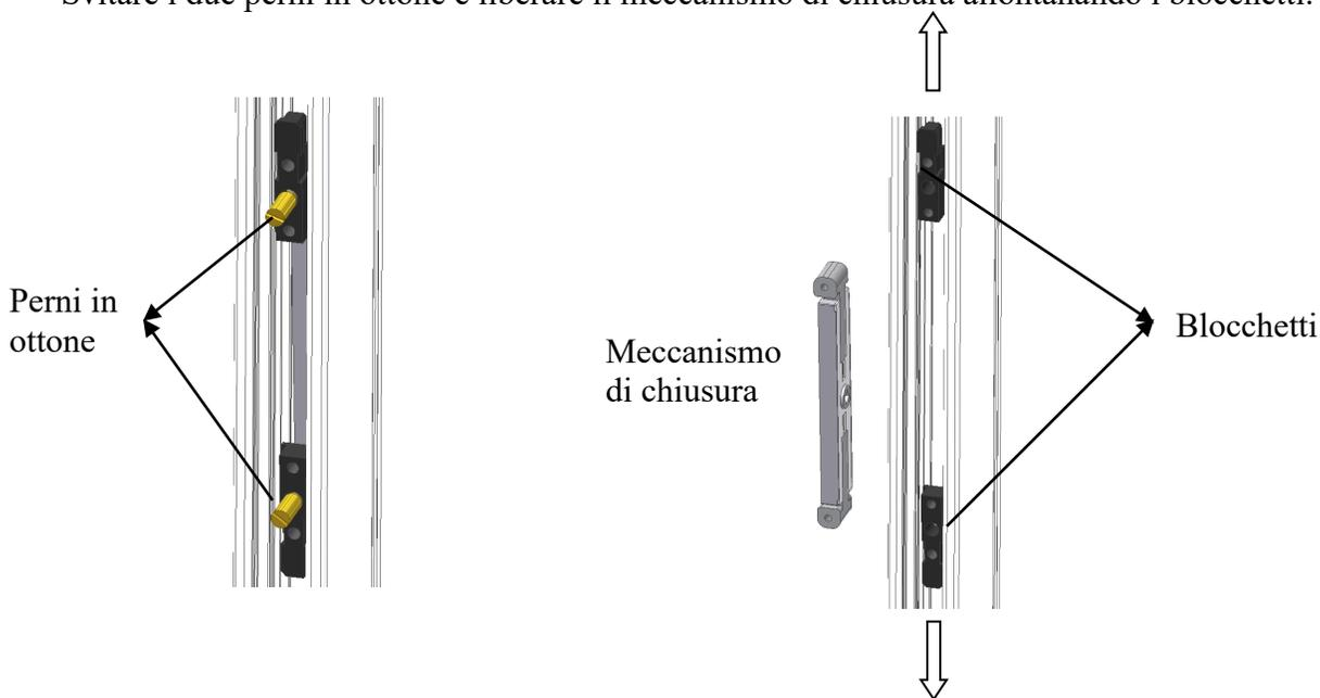
Sostituire il meccanismo di chiusura con uno nuovo e rimontare la maniglia usando il procedimento inverso a quello appena eseguito per lo smontaggio.
