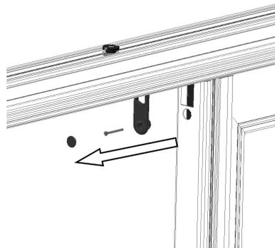
Estrarre l'anta dai binari (vedere pag 10), svitare le viti di fissaggio del carrello da sostituire, con un normale cacciavite taglio croce, estrarre il carrello vecchio e inserire il carrello nuovo.
